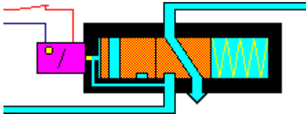
3/2 ventiel zonder luchtdruk, met spanning op de elektromagneet.
