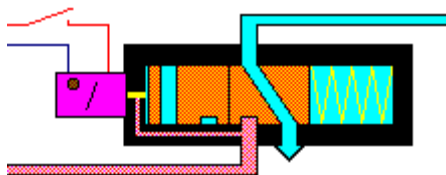
3/2 Ventiel met luchtdruk, zonder spanning op de elektromagneet.
